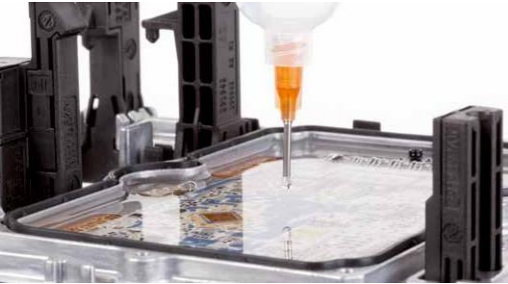
Schutz vor Vibrationen und Korrosion: Die Anzahl der elektronischen Komponenten in Autos nimmt ständig zu. Ein Verguss macht Steuerungen resistent gegen alles, was auf Fahrzeuge einwirkt: Vibrationen, Temperaturschwankungen und Feuchtigkeit. Bild: Verguss eines elektronischen Steuergeräts im Automobil mit WACKER SilGel® 612.
